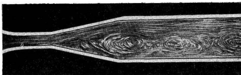
Фиг. 0-4. Отрыв потока от стенок при наличии положительного градиента давления (диффузор).
